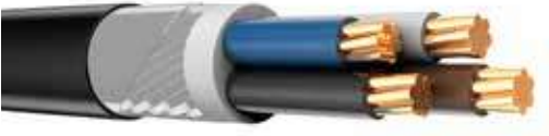
0,6/1 kV NYFGbY, Çok Damarlı Enerji Kablosu, Bakır İletkenli, PVC izoleli, Çelik Tel ve Bant Zırlı, PVC Kılıflı
